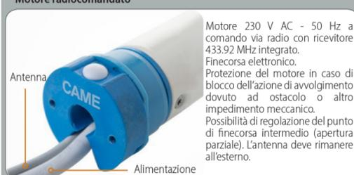
Motore 230 V AC - 50 Hz a comando via radio con ricevitore 433.92 MHz integrato. Finecorsa elettronico. Protezione del motore in caso di blocco dell'azione di avvolgimento dovuto ad ostacolo o altro impedimento meccanico. Possibilità di regolazione del punto di finecorsa intermedio (apertura parziale). L'antenna deve rimanere all'esterno.
