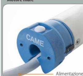
Motore a comando filare 230V AC - 50 Hz. Finecorsa elettronico via cavo. Protezione del motore in caso di blocco dell'azione di avvolgimento dovuto ad ostacolo o altro impedimento meccanico. Regolazione facile del finecorsa tramite pulsante sulla testa (esclusa Moovicaincasso) o con accessorio per la programmazione (optional).
